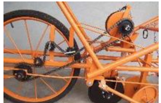
Montagem da corrente para o Rotor.
